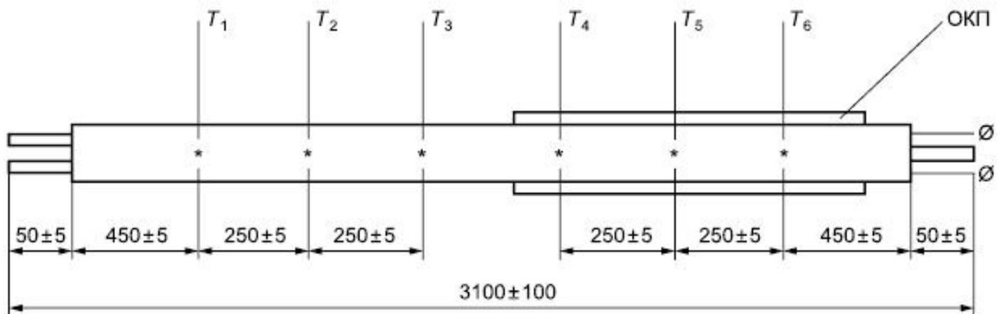
Рис.1 - Размещение термоэлектрических преобразователей
