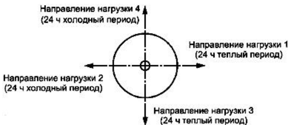
Рисунок 5 - Направления действия изгибающей нагрузки при термомеханических испытаниях
