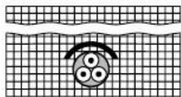
Бронированные одножильные или многожильные кабели, проложенные непосредственно в земле дополнительной механической защитой(
