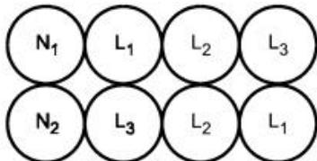
**Рисунок Н.52.2 - Специальная конфигурация для шести параллельных одножильных кабелей один выше другого (см. 523.7)**
