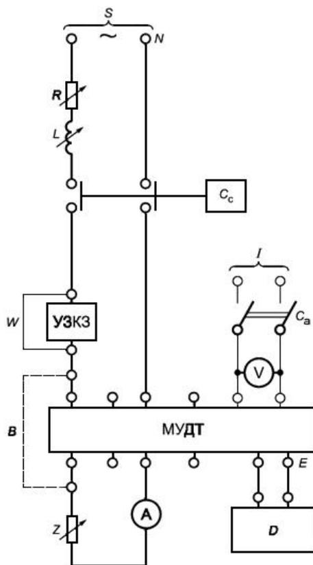
$S$  - источник питания;  $A$  - амперметр;  $C_c$  - выключатель короткого
