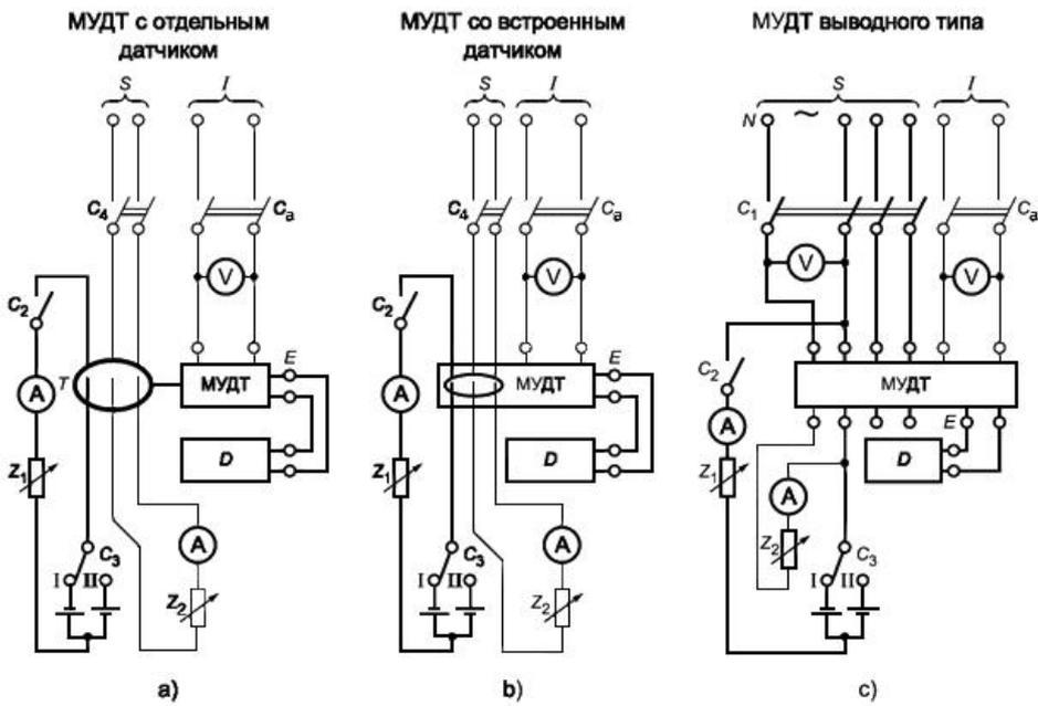
$S$  - источник питания;  $I$  - отдельный источник напряжения (при применении);
