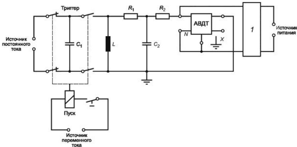
1 - фильтр;  $L = 5 \text{ мкГн}$ ;  $R_1 = R_2 = 25 \text{ Ом}$ ;  $C_1 = 0,5 \text{ мкФ}$ ;  $C_2 = 5 \text{ нФ}$ ;  $X$  - зажим заземления, если имеется, подсоединяемый к нейтральному зажиму, если он маркирован, или в отсутствие такой маркировки к любому фазному зажиму;  $N$  - нейтраль
