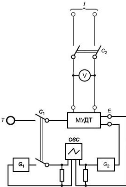
$I$  - отдельный источник напряжения (при применении);  $V$  - вольтметр;  $C_1$  - многополюсный выключатель;  $C_a$  - вспомогательный выключатель;  $T$  - датчик;  $E$  - выходная цепь;  $G_1$ ,  $G_2$  - генераторы;  $OSC$  - осциллограф
