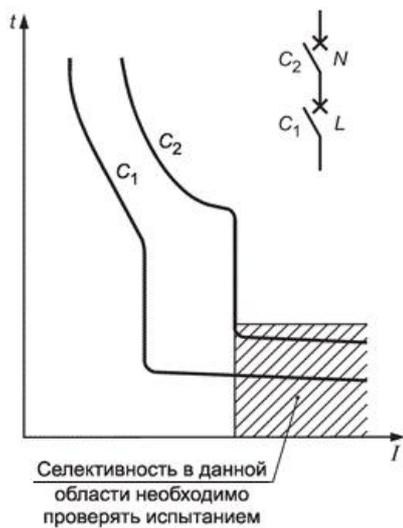
$C_1$  - токоограничивающий выключатель ( $L$ ) (характеристика времени отключения);  $C_2$  - нетокоограничивающий выключатель ( $N$ ) (характеристика срабатывания)
