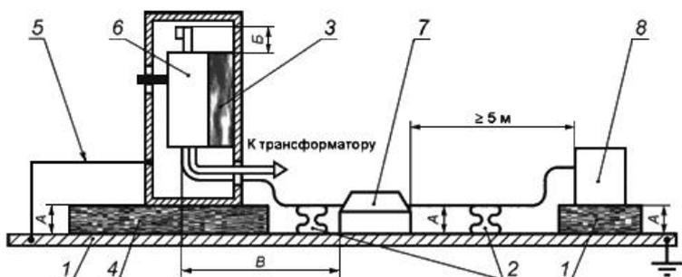
Размер *A* - (0,1-0,11) м; размер *B* - минимально возможный; размер *B* - (0,9-1,0) м (полная длина кабеля).
