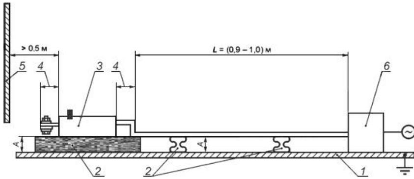
1 - заземляющая опора; 2 - изолирующие опоры; 3 - автоматический выключатель; 4 - должно быть сведено к минимуму; 5 - любая металлическая часть; 6 - трансформатор
