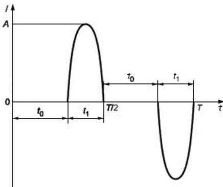
$A$  - пиковый ток;  $T$  - период;  $t_1$  - время прохождения тока в течение каждого полупериода;  $t_0$  - время паузы в течение каждого полупериода;
