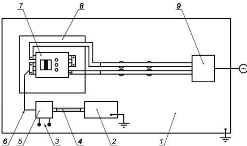
1 - заземляющая опора; 2 - высокочастотный генератор; 3 - сетевые выводы оставляют разомкнутыми; 4 - высокочастотное соединение; 5 - согласующее устройство M2; 6 - длина кабеля от 0,1 до 0,3 м; 7 - автоматический выключатель; 8 - изолирующая опора; 9 - трансформатор
