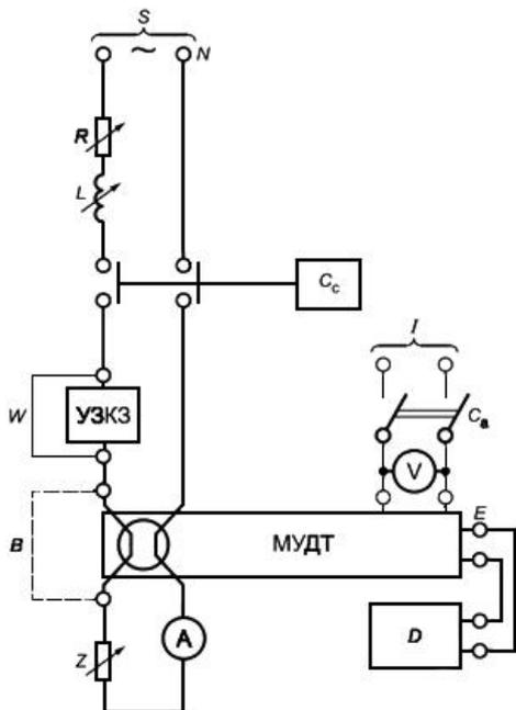
$S$  - источник питания;  $I$  - отдельный источник напряжения (при применении);
