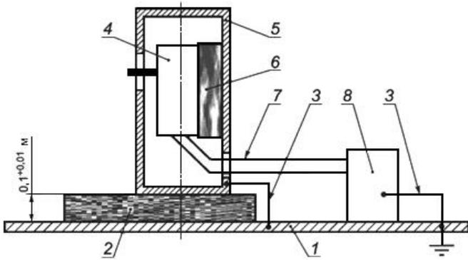
1 - заземляющая опора; 2 - изолирующая опора; 3 - высокочастотное соединение; 4 - ОПИ; 5 - металлическая оболочка; 6 - опора для испытательной металлической оболочки (см. рисунок J.1); 7 - питающий кабель, полная длина от 0,9 до 1,0 м; 8 - импульсный генератор
