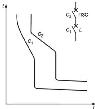
$C_1$  - нетокоограничивающий выключатель ( $N$ ) (характеристика времени отключения);
