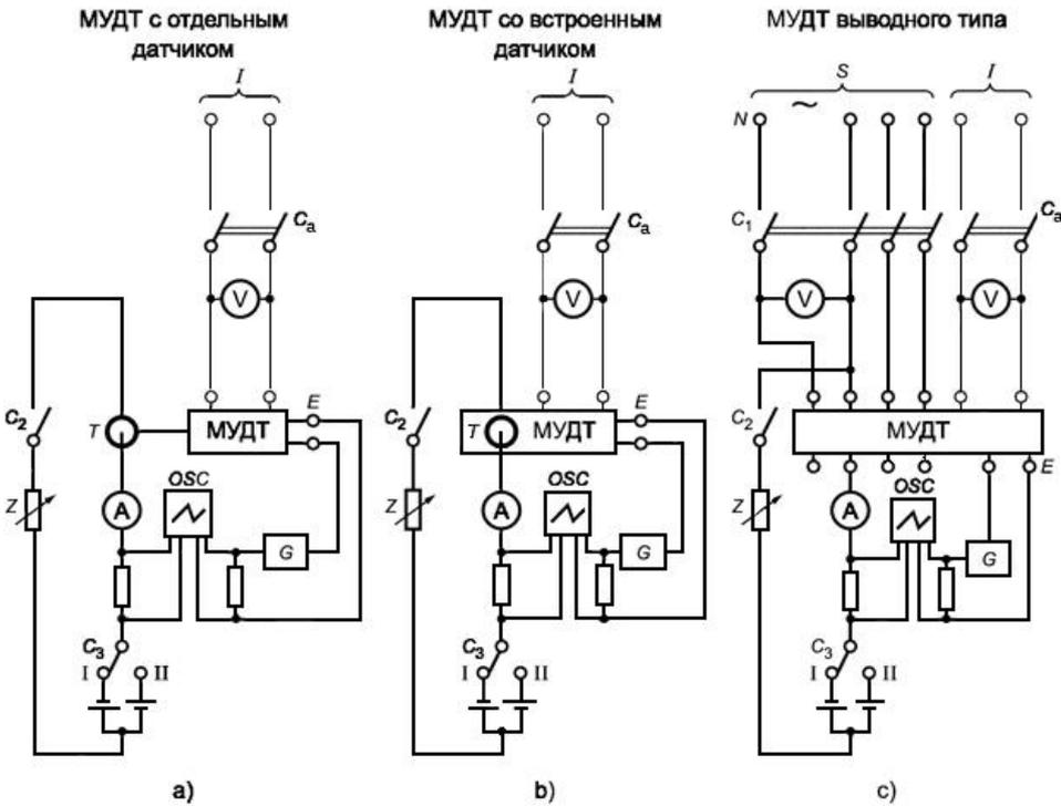
$S$  - источник питания;  $I$  - отдельный источник напряжения (при применении);
