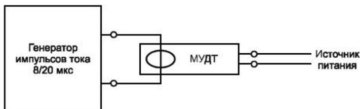
б) МУДТ со встроенным датчиком
