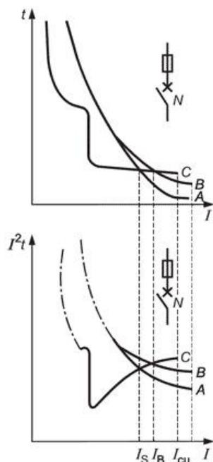
$I$  - ожидаемый ток короткого замыкания;  $I_{сц}$  - номинальная предельная наибольшая отключающая способность (4.3.5.2.1);  $I_{\Sigma}$  - предельный ток селективности (2.17.4);  $I_B$  - ток координации (2.17.6);  $A$  - преддуговая характеристика плавкого предохранителя;  $B$  - рабочая характеристика плавкого предохранителя;  $C$  - рабочая характеристика нетокоограничивающего выключателя ( $N$ ) (время отключения/ток и  $I^2t$ /ток);  $\bar{N}$  - нетокоограничивающий выключатель.
