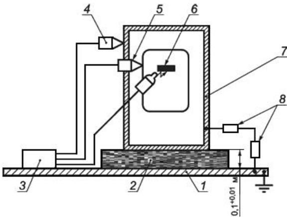
1 - заземляющая опора; 2 - изолирующая опора; 3 - испытательный генератор; 4 - разряды при непрямом воздействии, прикладываемые к оболочке; 5 - разряды при прямом воздействии, прикладываемые к проводящим доступным частям; 6 - разряды, прикладываемые по воздуху к непроводящим доступным частям; 7 - металлическая оболочка по рисунку J.1; 8 - два сопротивления по 470 кОм, заменяющие высокочастотное соединение на рисунке J.1
