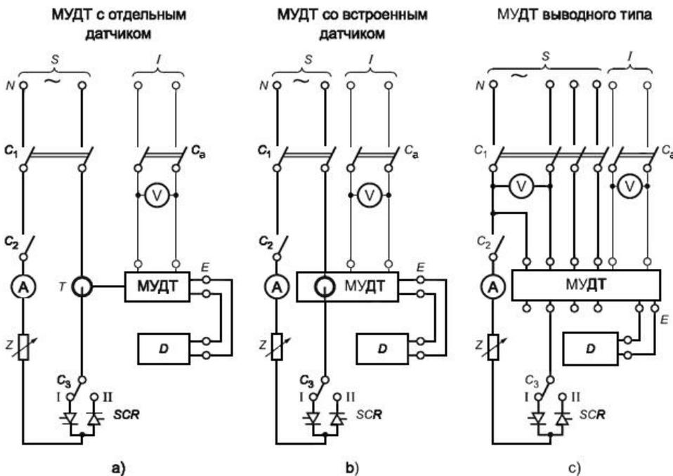
$S$  - источник питания;  $I$  - отдельный источник напряжения (при применении);
