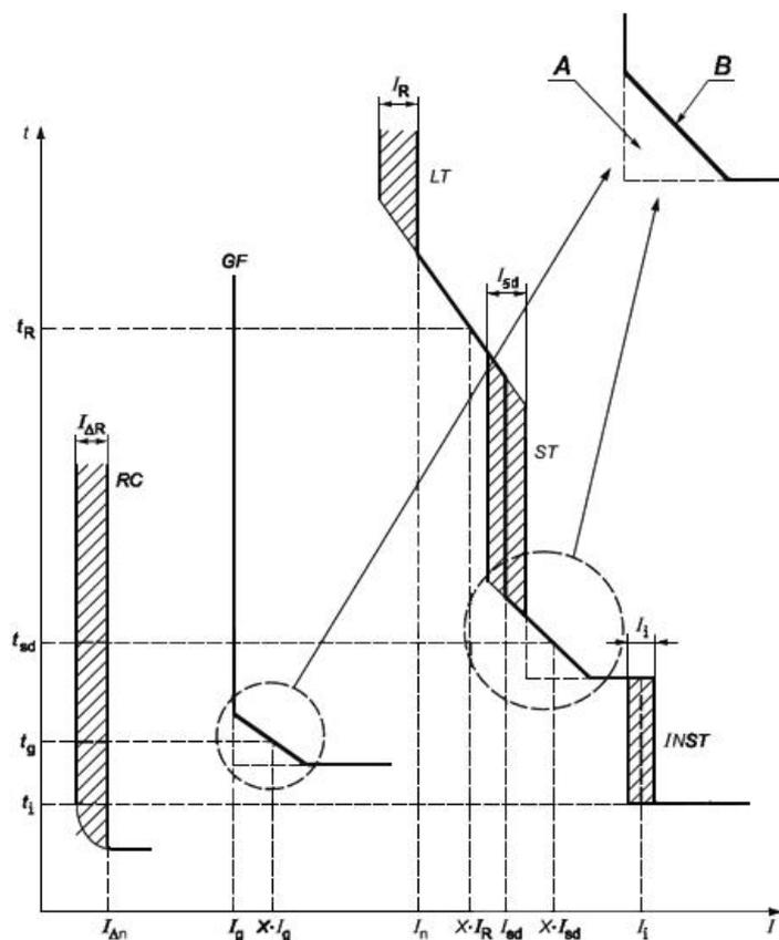
$A$  - характеристика до  $I^2 t$ ;  $B$  - характеристика  $I^2 t$ ;  $RC$  - дифференциальный ток;  $GF$  - замыкание на землю;  $LT$  - длительное время;  $ST$  - кратковременно;  $INST$  - мгновенно
