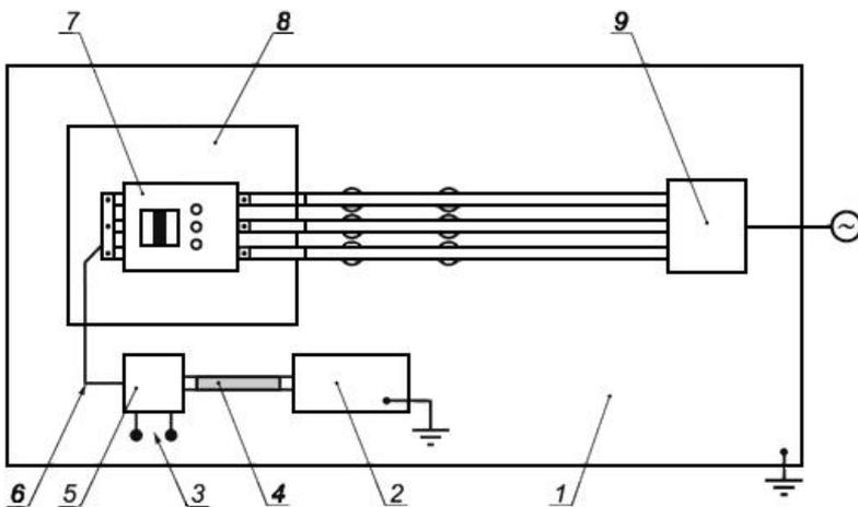
1 - заземляющая опора; 2 - высокочастотный генератор; 3 - сетевые выводы оставляют разомкнутыми; 4 - высокочастотное соединение; 5 - согласующее устройство M1 (M2 для рисунка F.22); 6 - длина кабеля от 0,1 до 0,3 м; 7 - автоматический выключатель; 8 - изолирующая опора; 9 - трансформатор
